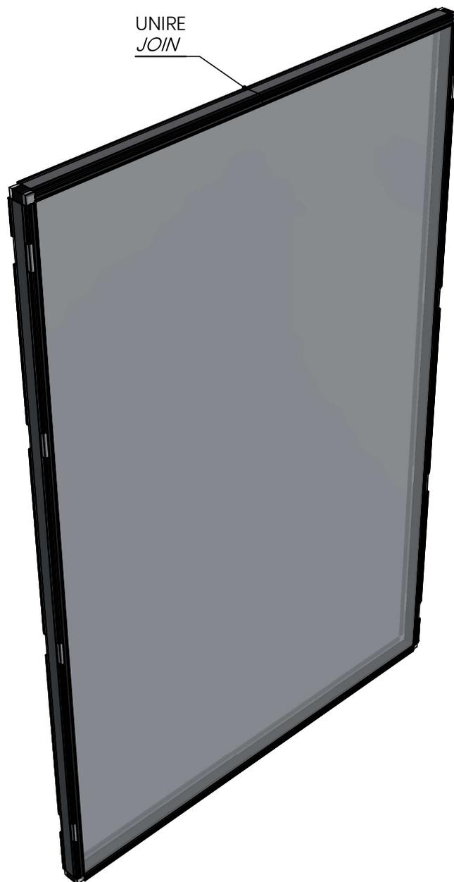
\* Tagliare e unire V04000 nella parte superiore dell'unità utilizzando colla cianoacrilata prima di assemblare il profilo. La mancata giunzione corretta della guarnizione può causare l'ingresso di acqua o uno spostamento della stessa quando assemblata.
