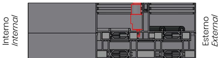
Posizionare H00411 nell'angolo del telaio esterno come mostrato.
